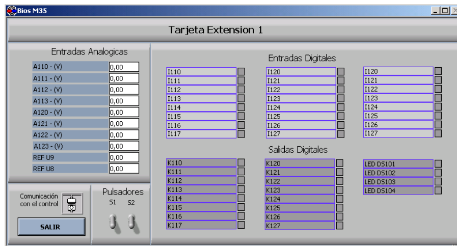
Figura E-7. Pantalla monitor de la tarjeta extensión 1 del programa BIOS M35
